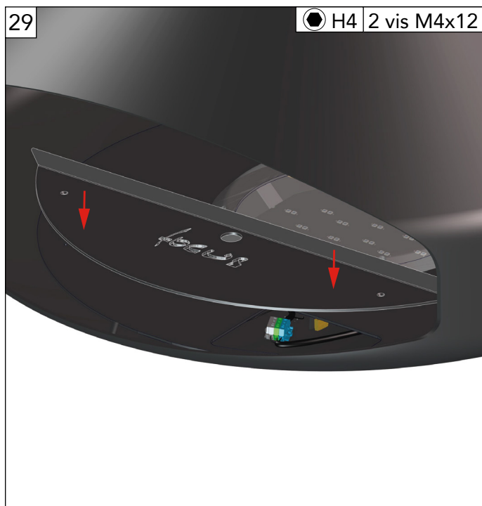
Remontez le support du verre holographique et resserrez les 2 vis.
